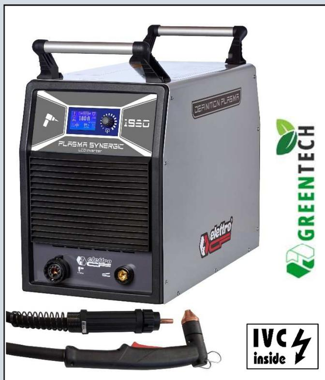
Il generatore trifase per il taglio dei metalli al plasma ad aria compressa, **PLASMA 1980 SYNERGIC LCD INVERTER** è dotato di una innovativa tecnologia **SINERGICA PLASMA** che imposta automaticamente tutti i parametri di taglio in base alle informazioni ricevute dall'operatore riguardo al materiale in lavorazione ed al processo selezionato.
